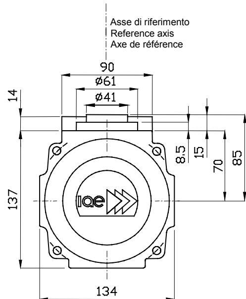
**Dimensioni della finestra raggi / Output port dimensions / Dimensions de la fenêtre de sortie**
