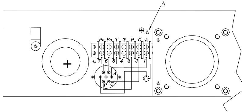
**Collegamenti di alta tensione / High voltage connections / Connexions haute tension**
