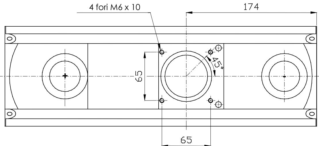
Il blocco finestra è fornito di 4 fori filettati M6 per installare il complesso tubo guaina sul sistema e il collimatore sul complesso tubo guaina.
