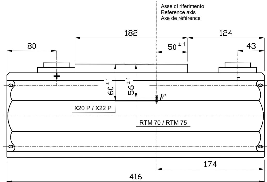
F: Posizione delle macchie focali / focal spots position / position des foyers
