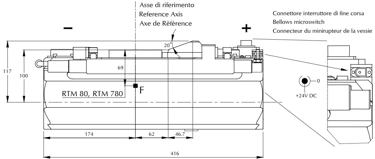
**F:** Posizione delle macchie focali / focal spots position / position des foyers
