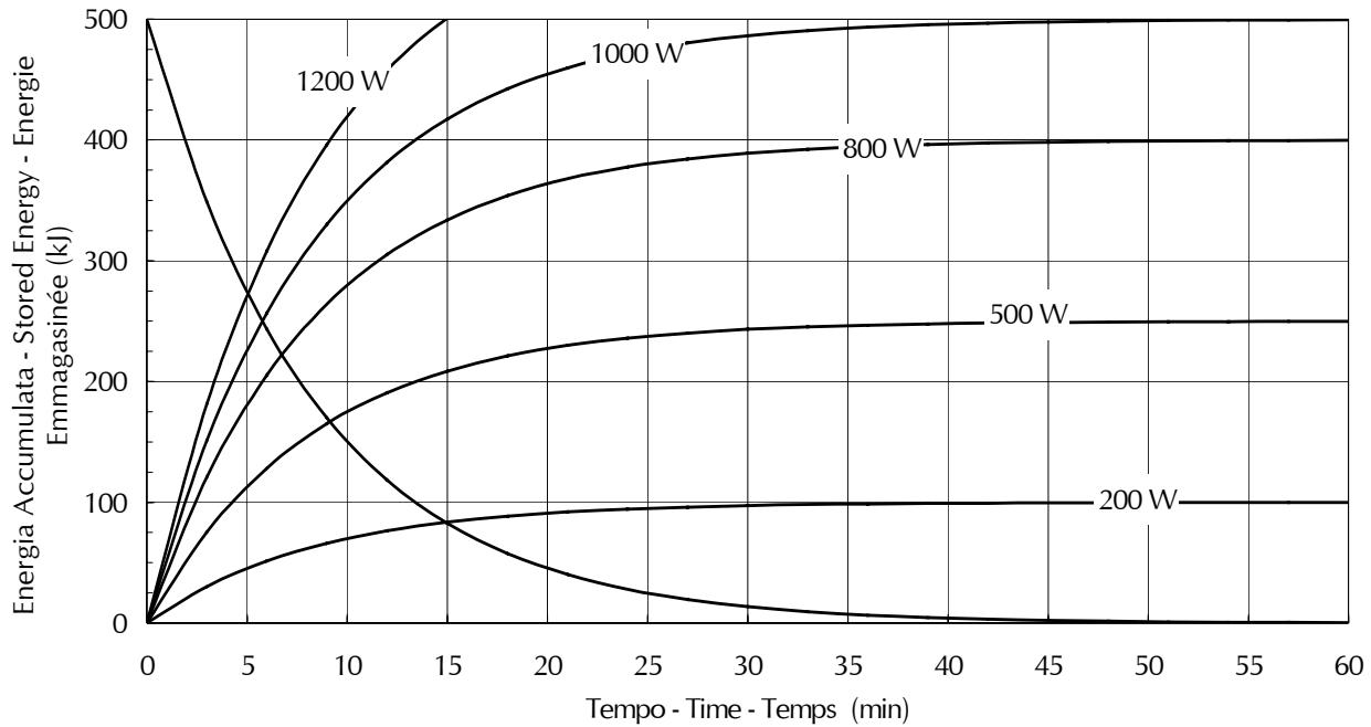
Con scambiatore di calore HE31 / With heat exchanger HE31/ Avec échangeur HE31
