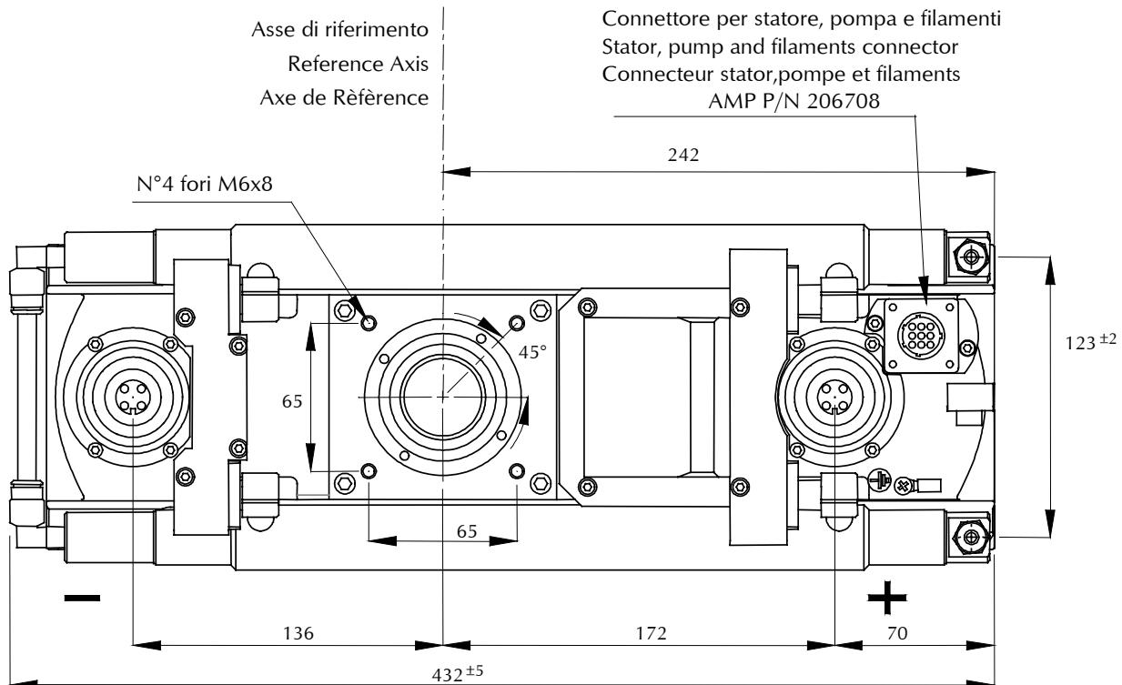
Il blocco finestra è fornito di 4 fori filettati M6 per installare il complesso tubo guaina sul sistema e il collimatore sul complesso tubo guaina.
