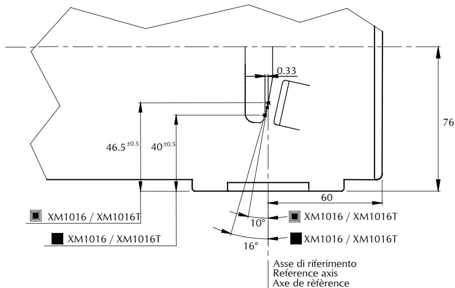
**Posizione delle macchie focali / Focal spots position / Position des foyers XM12/ XM15/ XM12T/
