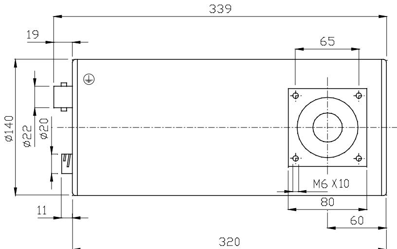
Il blocco finestra è fornito di 4 fori filettati M6 per installare il complesso tubo guaina sul sistema e il collimatore sul complesso tubo guaina.
