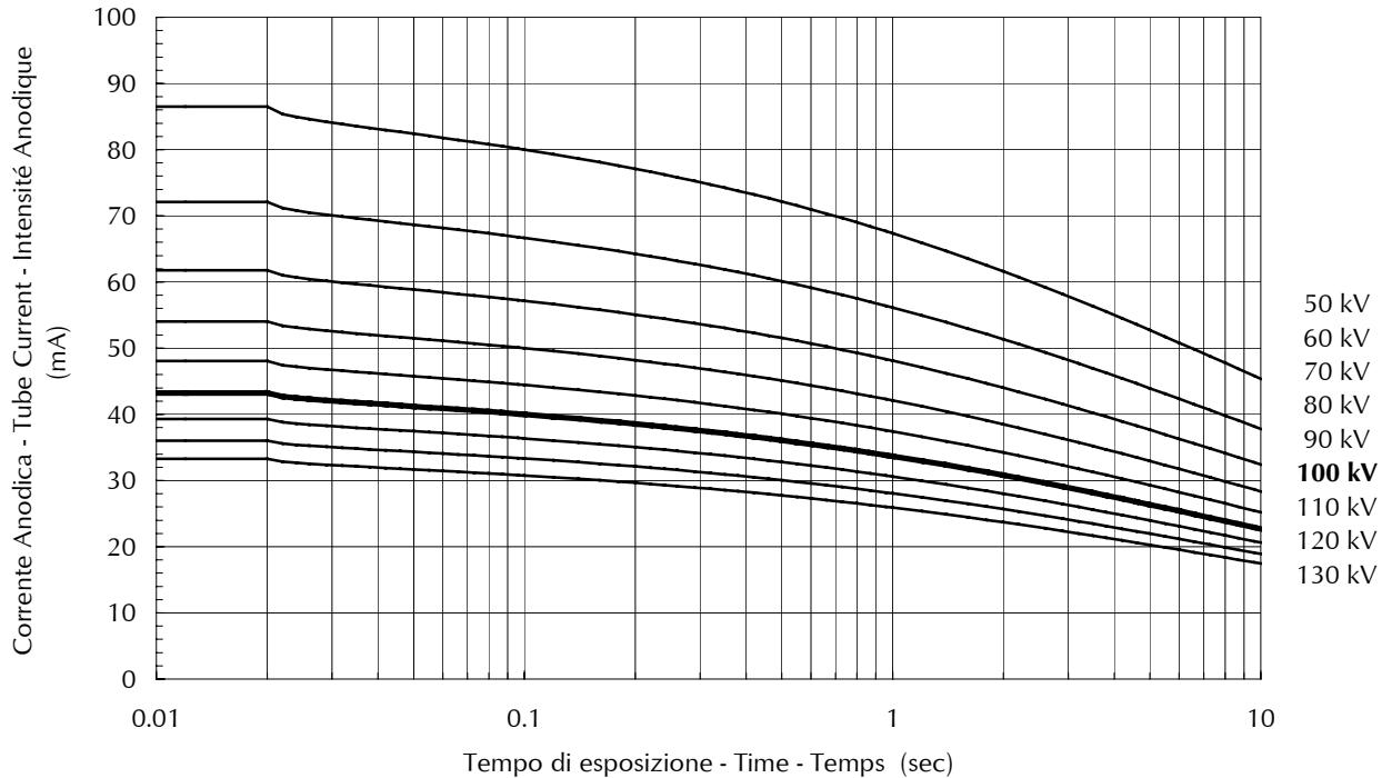
**CURVE DI CARICO SINGOLO - SINGLE LOAD RATING - ABAQUE DE CHARGE UNIQUE**
